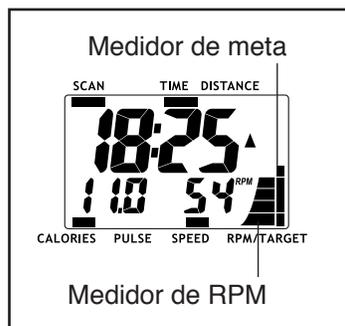
Si su velocidad de pedaleo es inferior a la meta de velocidad actual, se mostrará una flecha al lado del medidor de RPM para indicarle que aumente su velocidad; si su velocidad de pedaleo es superior a la meta de velocidad, una flecha le indicará que disminuya su velocidad.
