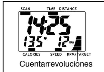
Al incrementar o reducir su velocidad de pedaleo, aparecen o desaparecen barras del RPM.
